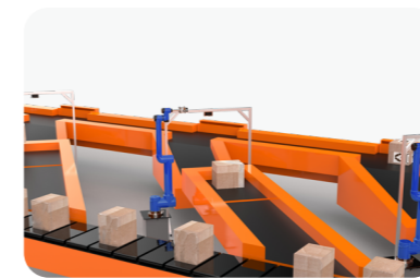
Система последовательного захвата посылок из контейнера
