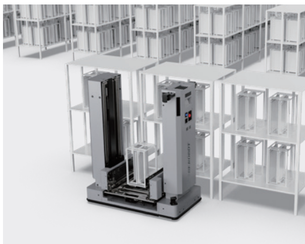
Транспортировка и доставка у линии, стыковка с буферным стеллажом
