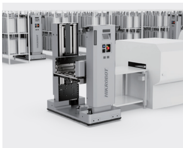
Стыковка с верхним и нижним штабелерами пластин, передача рамок печатных плат
