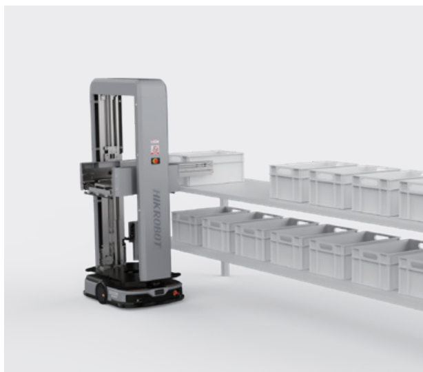
Доставка контейнеров на проточный стеллаж у линии
