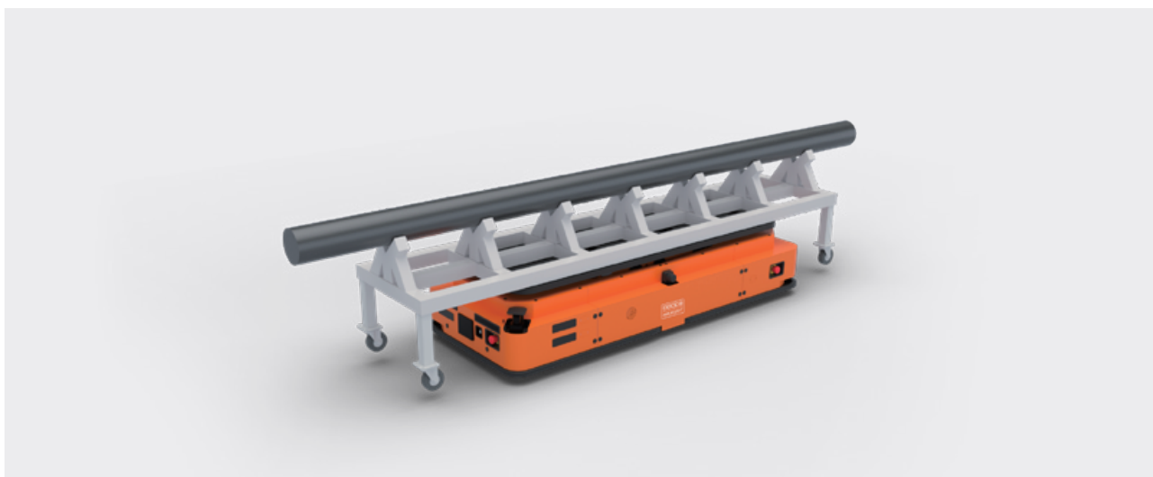
Транспортировка длинных кремниевых слитков
