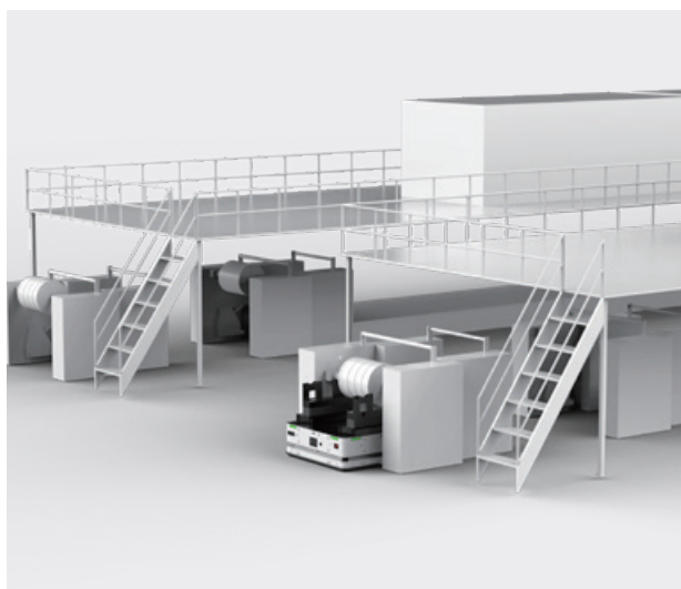
Загрузка рулона с покрытием (замена пустого вала на загруженный рулон)
