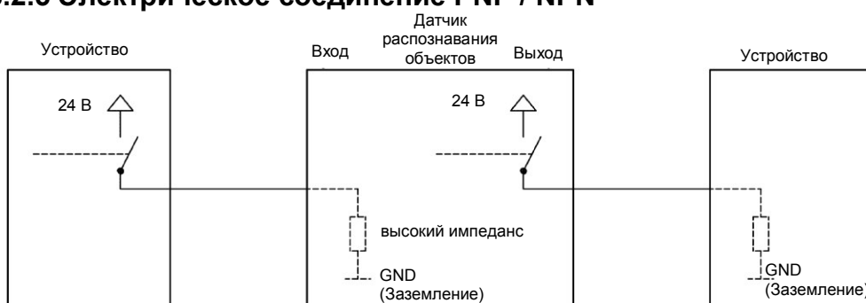
Рис. 5: Пример подключения для VISOR® в режиме PNP. Входы/выходы переключены в +24 В
