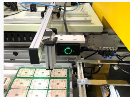
Считывание кодов на печатных платах с подложками разного цвета
