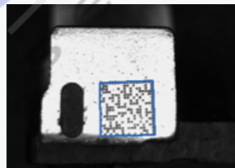
Размеры кодов становятся всё меньше и меньше. Промышленные считыватели серии ID с высоким разрешением обеспечивают стабильное считывание очень мелких кодов.
