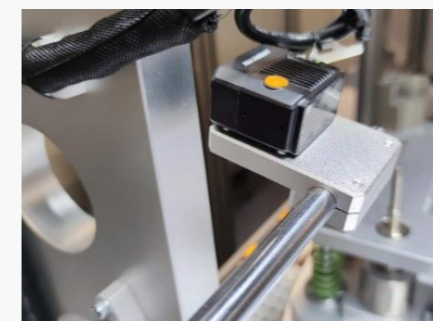
Считывание кода с крышки электронного блока управления
