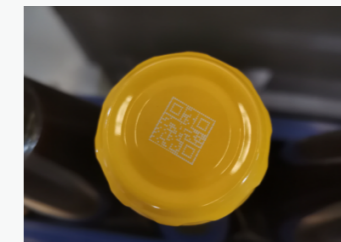
Два считывателя объединены в группу ведущий-ведомый и распознают QR-код на крышке бутылки. Считыватели решают проблемы высокой скорости, бликов, низкоконтрастной печати и смазывания печатной информации. Стабильность считывания более 99%.
