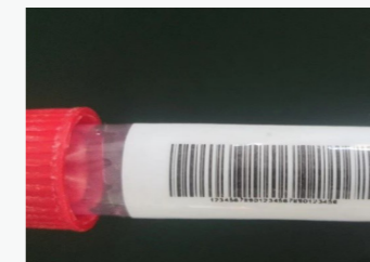
Код Code128 может быть в любом месте пробирки. Проблемы с бликами, искажениями и высокоскоростным движением пробирок. Стабильность считывания более 99,9%.
