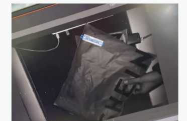
Считыватель кодов распознаёт 2D-коды на посылках и выполняет их сортировку на основе полученных данных. Считыватель решает проблему искажения и сминания этикетки с кодом. Стабильное считывание более 99,9% кодов.
