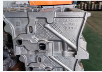
На разных литых деталях код DataMatrix выгравирован по-разному, меняется его положение и требуется хорошая глубина резкости. Решение легко переносить с места на место. Считывание до 99,9 % кодов.
