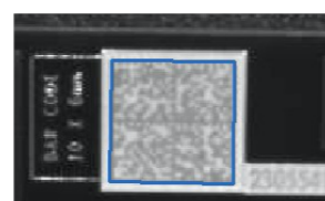
Низкоконтрастный код прямой маркировки (DPM)
