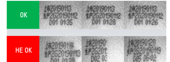
Обнаружение дефектов маркировки на упаковках пищевой продукции.
