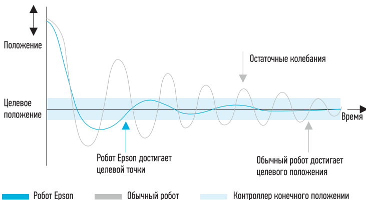
РИС. 2. Сравнение показателей точности позиционирования и времени цикла обычных роботов и роботов Epson с технологией Smart Motion
