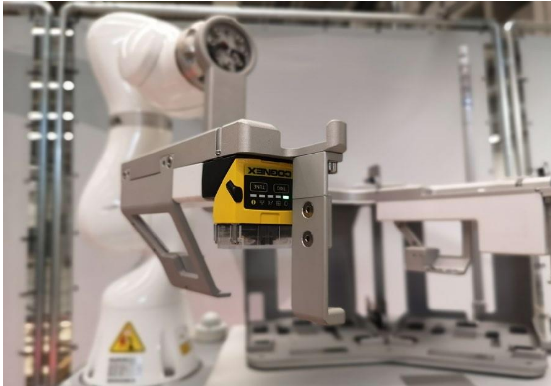
Рис. 2. Сам процесс захвата управляется с помощью обработки изображений.
