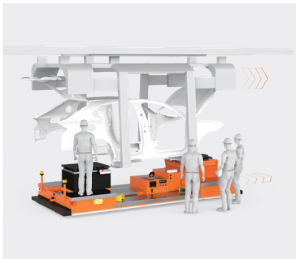
Транспортировка с подъёмом вдоль сборочной линии
