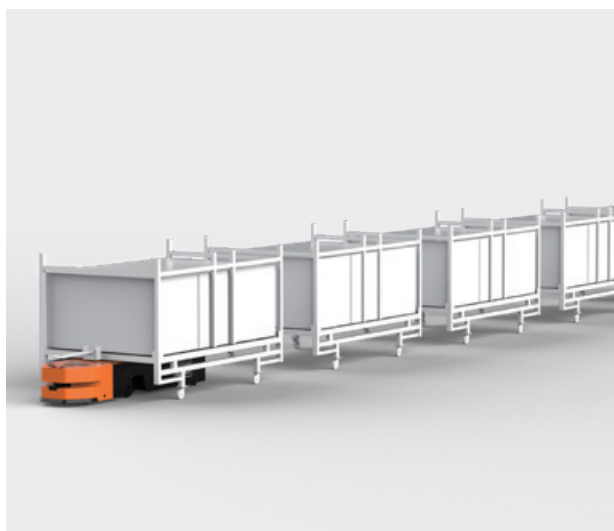
Перевозка нескольких тележек одним AMR
