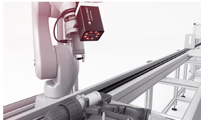
VISOR® Robotic определяет точное положение корпуса видео-датчика. Данные о смещении используются для корректировки траектории движения робота.
