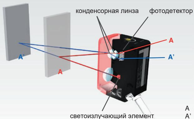
Датчики с подавлением заднего фона, работающие по принципу триангуляции, обеспечивают стабильное обнаружение объекта независимо от его цвета и внешних условий.
