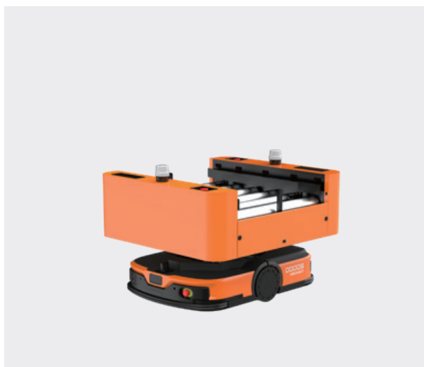
Роликовое оборудование верхнего слоя
