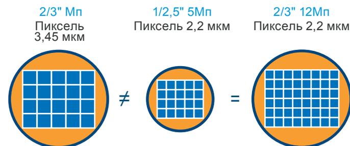
Рис. 1: Разрешение объектива 5 Мп формата 1/2,5" приближено к 12 Мп с объективом формата 2/3"
