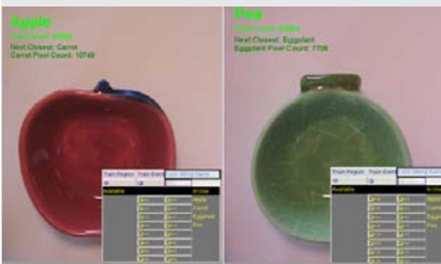
Инструменты цветного зрения используются для идентификации и проверки объектов на основании данных о цветах. С помощью этих инструментов также проводятся измерения количества имеющихся в наличии пикселей цвета или группы цветов. Усовершенствованная технология цветного машинного зрения обеспечивает точность даже при изменении освещения, которое может создать проблемы при использовании традиционных инструментов цветного машинного зрения.
