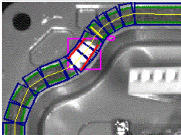
Инструменты для работы с кромками распознают на детали переходы от темного к светлому. Результаты работы этого инструмента могут использоваться для измерения расстояний, а также для проверки путем подсчета обнаруженных кромок. Также инструмент может использоваться для обнаружения и измерения кругов и кривых. Инструмент InspectEdge отслеживает кромку детали для проверки на наличие дефектов.
