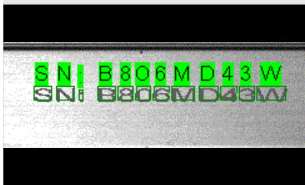
Инструмент оптического распознавания и проверки символов сегментирует, извлекает и формирует шрифты для оптического считывания символов (OCR) и оптической проверки символов (OCV) на изображении. Инструмент с возможностью обучения шрифтам точно считывает символы с низкой контрастностью или с неравномерным расстоянием между символами на сложных фонах.
