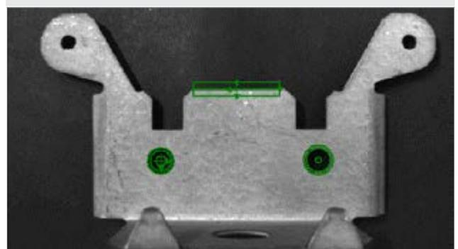
Инструменты геометрии используются для измерения важнейших размеров детали с интерактивной простотой. Углы, кривые, диаметры и расстояния от точки до линии используют калибровку в реальных размерах для обеспечения точных и постоянных результатов.
