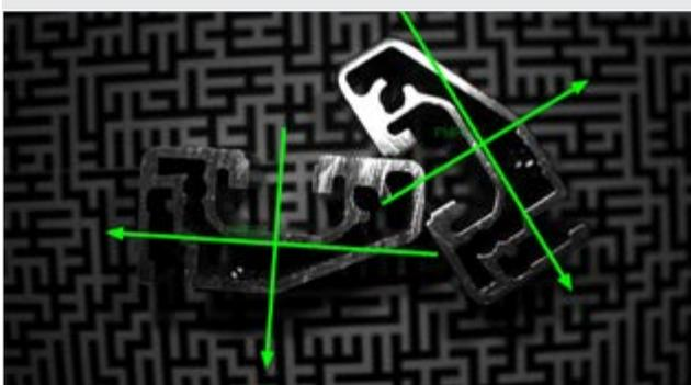
Точное определение местоположения детали – первый шаг для большинства программ машинного зрения. Лучшие в отрасли технологии сопоставления образов Cognex, такие как PatMax RedLine, обеспечивают беспрецедентную точность и надежность даже при вращении, масштабировании и изменении освещения.
