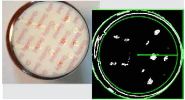
Усовершенствованная фильтрация изображений используется для выделения или удаления геометрических элементов деталей перед дальнейшей обработкой с помощью других инструментов машинного зрения.
