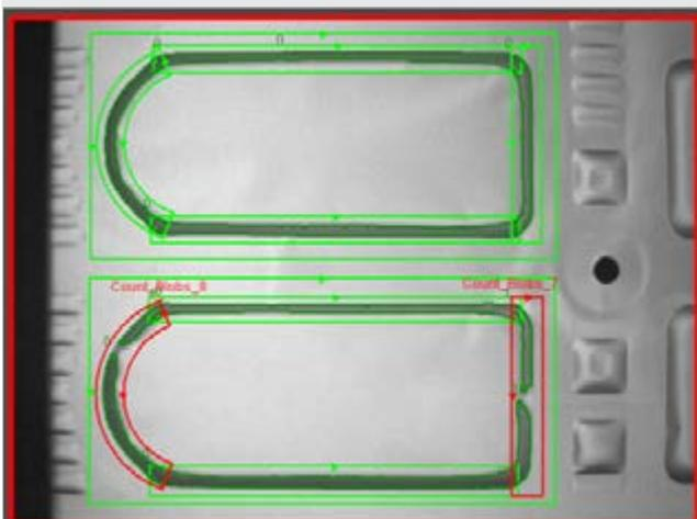
Инструменты для обнаружения пятен используются для выявления геометрических элементов с похожими градациями серых оттенков. Эти инструменты очень полезны при расчете размеров дефектов или определении местоположения геометрических элементов, не имеющих постоянной формы. Они могут использоваться для монохромных и цветных изображений в целях подсчета количества имеющихся цветов.
