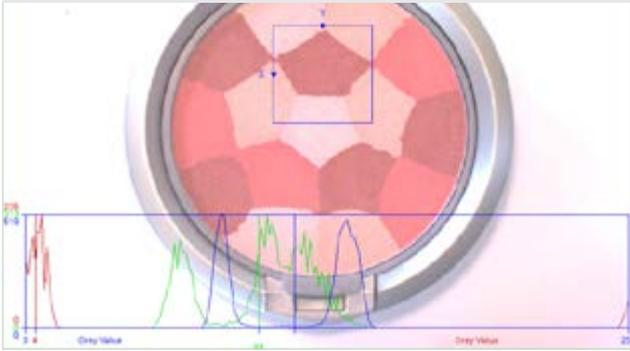
Гистограммы используются для проверки и мониторинга геометрических элементов деталей на основании яркости.
