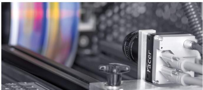
Изъяны разных размеров означают различные задачи для операторов. Камеры Basler raser предлагаются с разрешением 2k, 4k, 6k, 8k и 12k пикселей, благодаря чему их можно использовать для выявления даже мельчайших дефектов в материалах различных видов. Благодаря своей высокой чувствительности и производительности в динамических условиях, они с первого прохода способны выявлять дефекты даже при низком уровне их контрастности.
