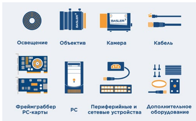
Компоненты системы машинного зрения
