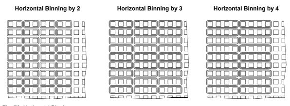
Fig. 73: Horizontal Binning
