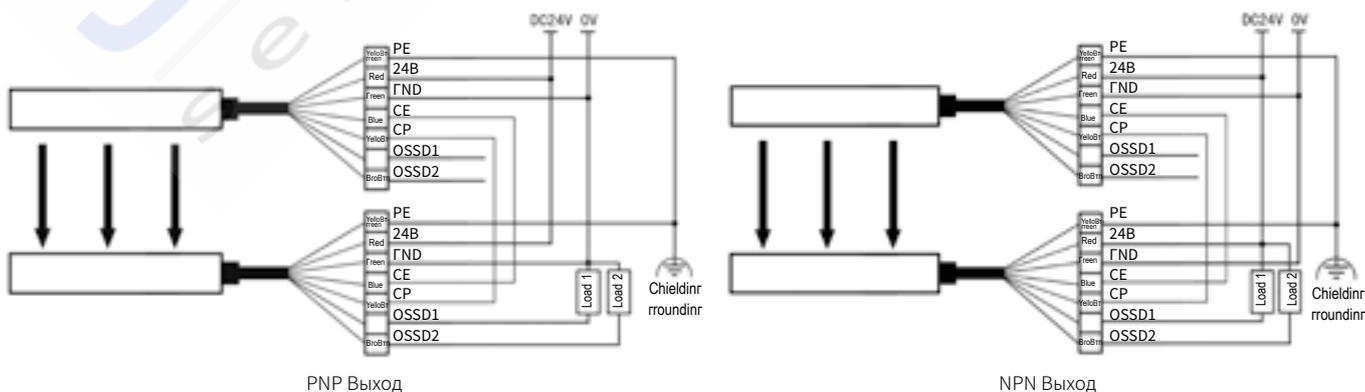
Примечание. Провода управляющих сигналов OSSD1 и OSSD2 на конце излучателя являются контактными.
