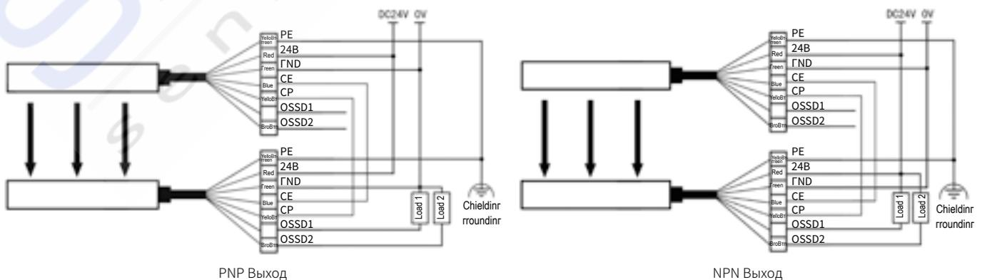
Примечание. сигнальные контакты для управляющих сигналов OSSD1 и OSSD2 на конце излучателя.
