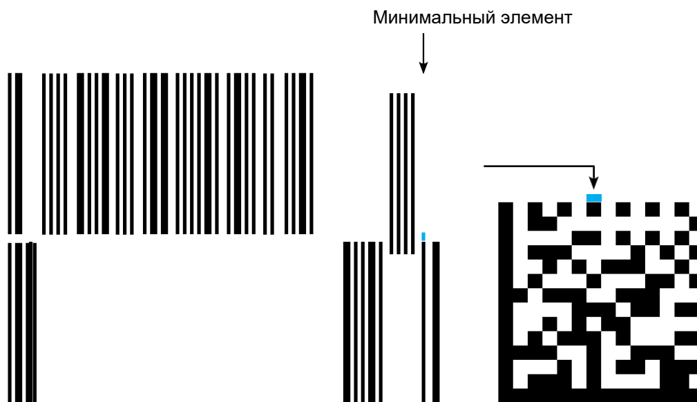
Рис. 5. Разрешение камеры диктуется размером минимального элемента кода
