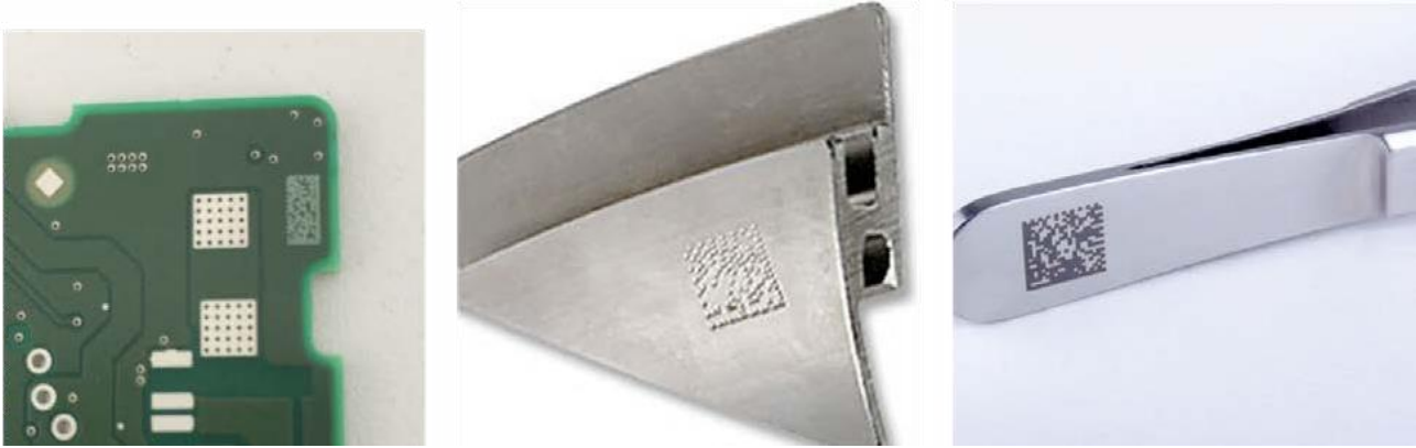
Рис 2. Коды прямой маркировки (DPM) широко используются во многих отраслях, требующих верификации.
