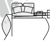
Рис. 9 Снятие отводной втулки с помощью отводной гайки
