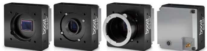
Рис. 1. Камера Basler boost по запросу предлагается с креплением F-Mount, C-Mount или M42. Коаксиальный кабель подключается к камере разъемом Micro-BNC (HD-BNC) и используется как для передачи данных, так и подачи питания на камеру. Это означает, что вам потребуется всего один кабель, то существенно упрощает кабельные соединения и архитектуру системы.
