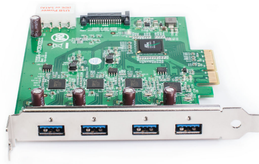
Рис. 4. Плата USB 3.0 на PCI-Express с четырьмя независимыми портами USB 3.0 для передачи данных. Fresco FL1100, 4 хост-контроллера, x4, 4 порта
