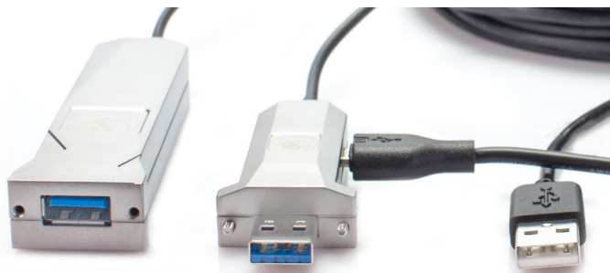
Рис. 3. Удлинительный кабель USB 3.0. Также требуется пассивный кабель. На стороне основного устройства необходим второй USB-порт для подачи питания.
