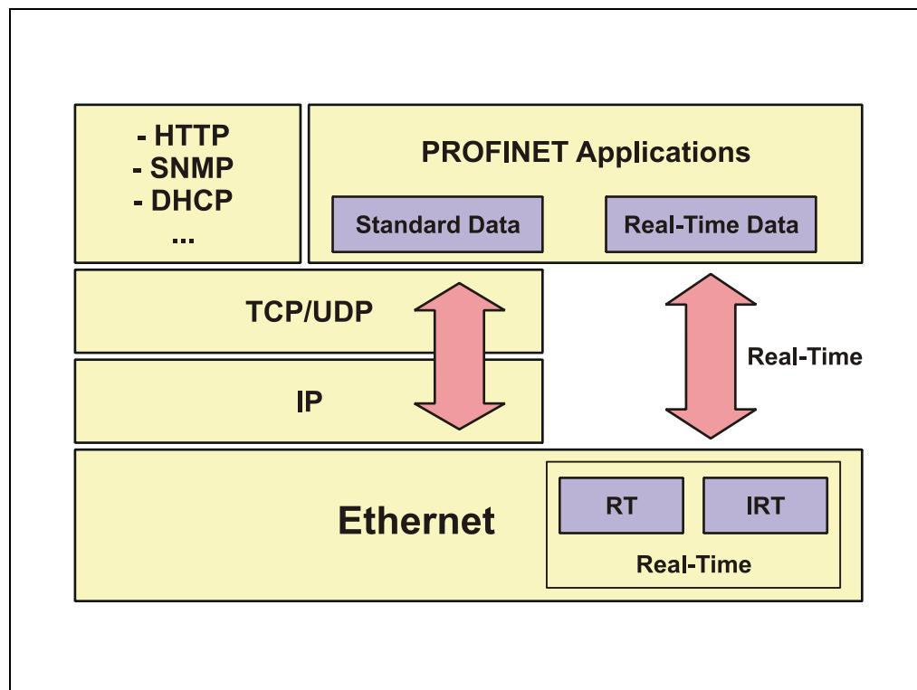
Abbildung 2: PROFINET Kommunikationsmechanismus
