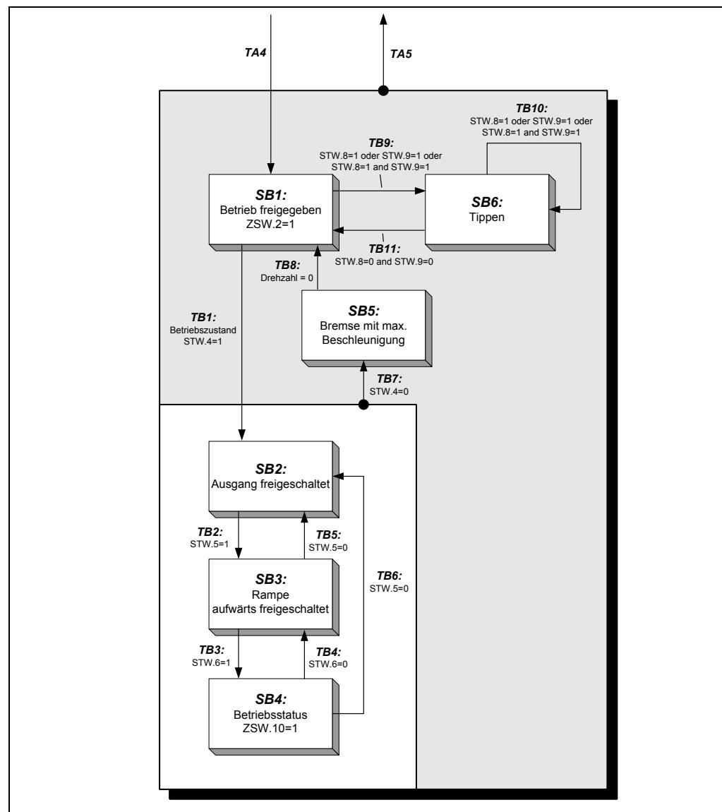
Abbildung 11: PROFIdrive Zustandsmaschine, Betriebsart Geschwindigkeitsregelung
