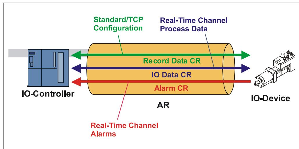
Abbildung 22: Gerät-Kommunikation
