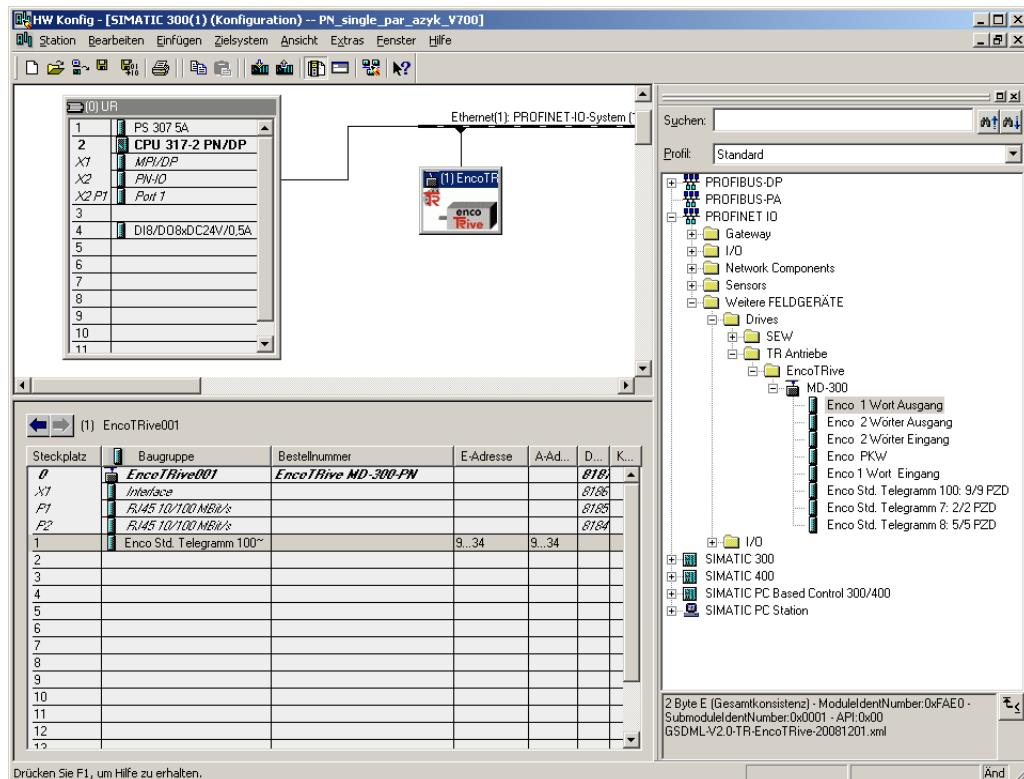
Abbildung 28: encoTRive in das Netzwerk mit aufnehmen
