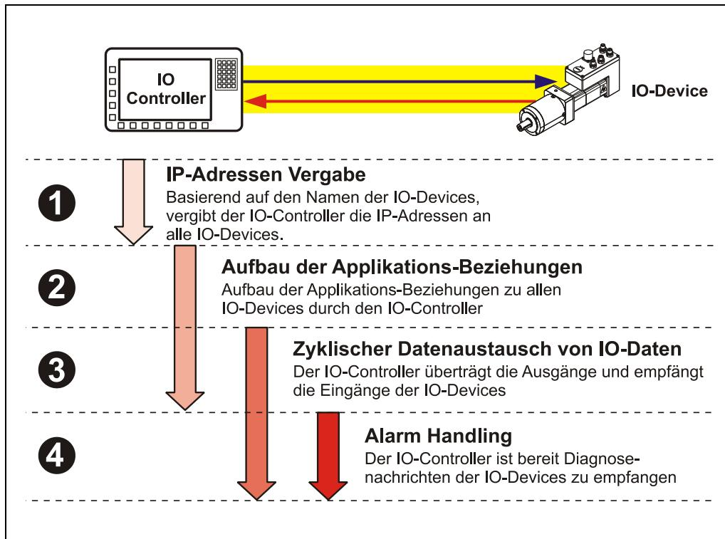
Abbildung 4: PROFINET Systemhochlauf
