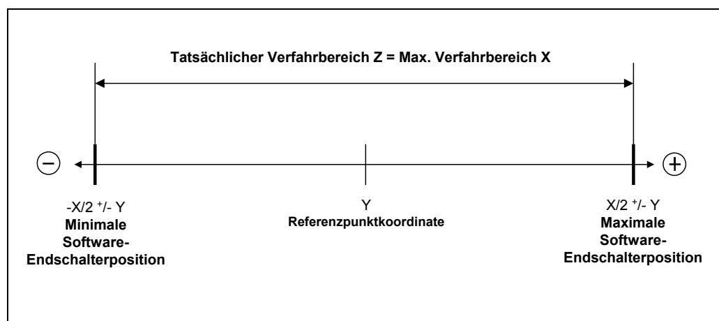
Abbildung 16: Software-Endschalterpositionen / Referenzpunktkoordinate
