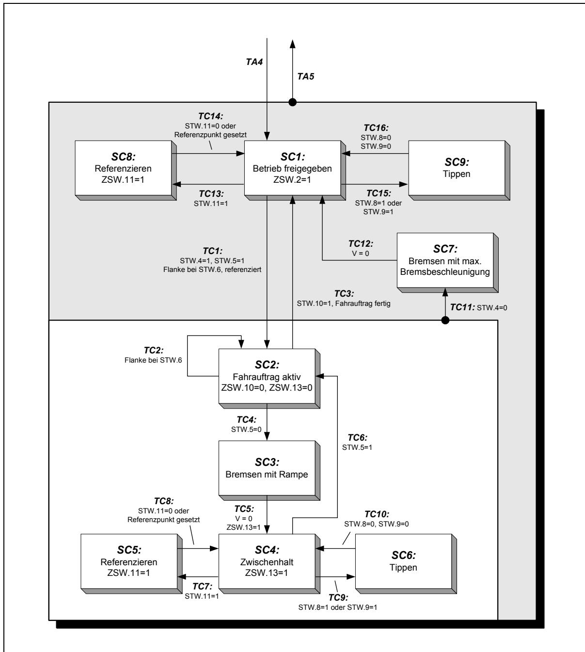
Abbildung 9: PROFIdrive Zustandsmaschine, Betriebsart Positionieren
