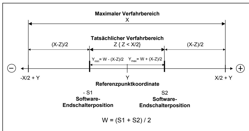
Abbildung 17: Maximale Referenzpunktkoordinate,  $Z < X/2$
