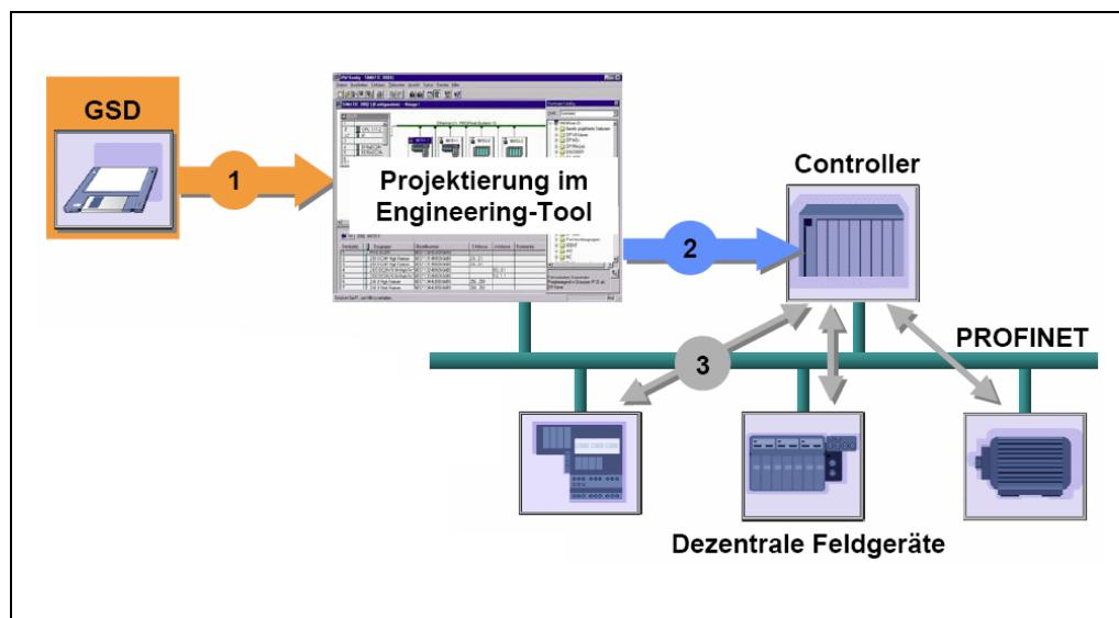
Abbildung 21: GSDML-Datei für die Konfiguration [Quelle: PROFIBUS International]
