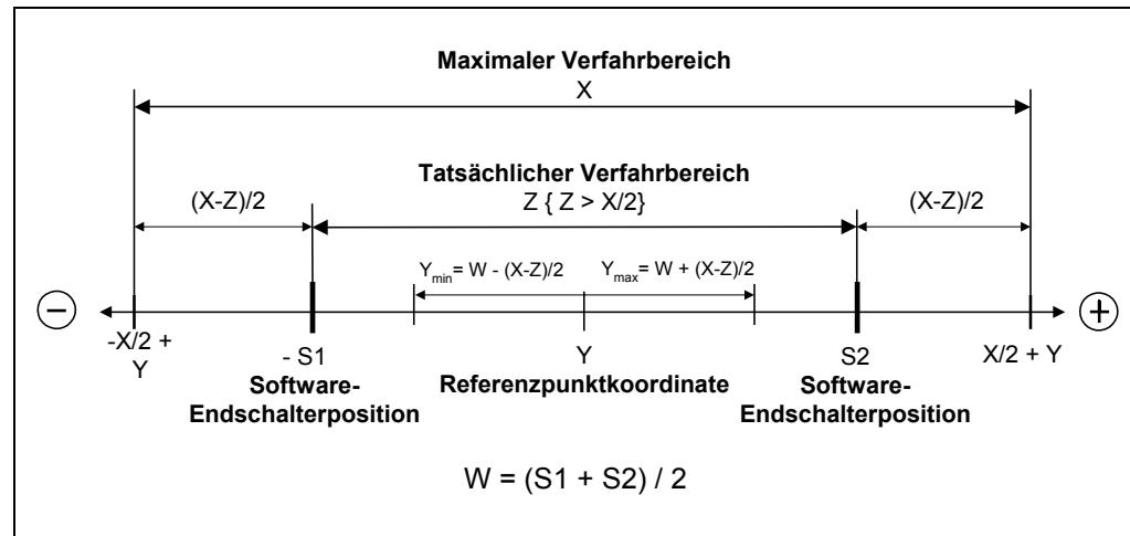
Abbildung 18: Maximale Referenzpunktkoordinate,  $Z > X/2$
