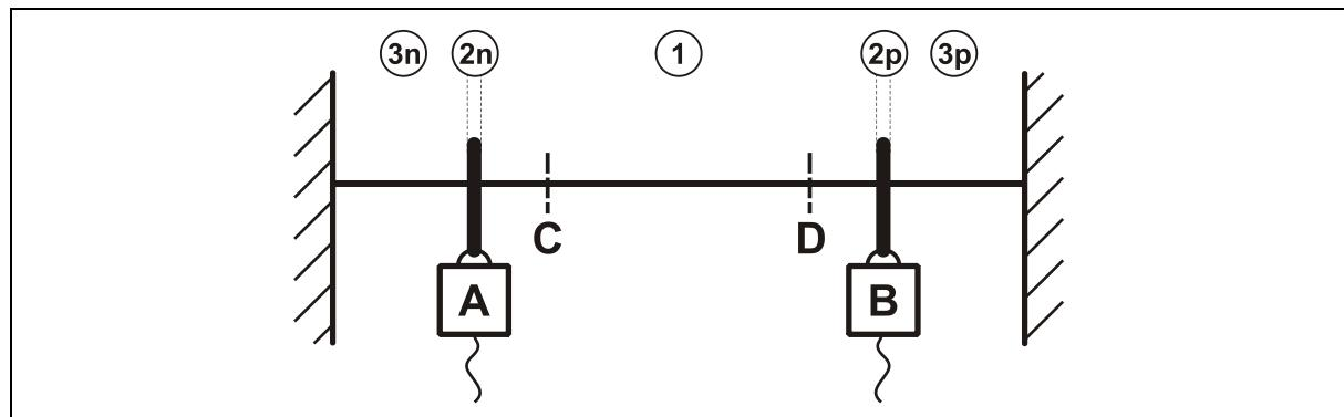
Abbildung 20: Funktionsprinzip Hardware-Endschalter
