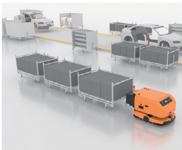
Буксировка трёх тележек одним AMR
