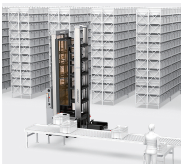
Полная приёмка и отгрузка контейнеров со склада через конвейер
