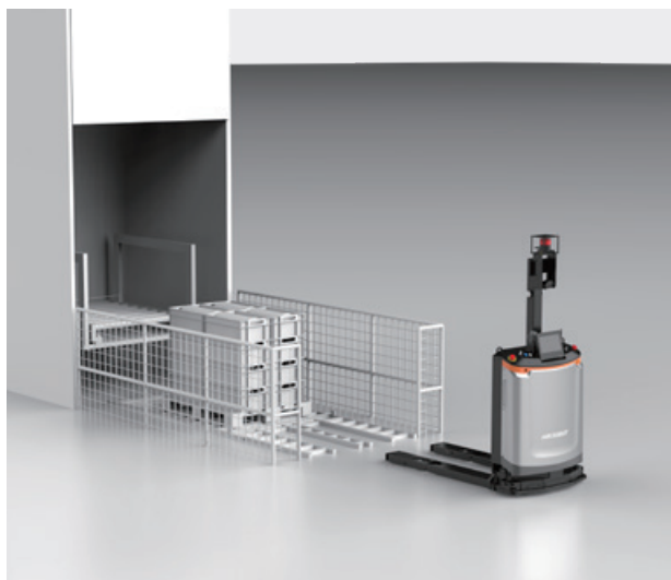
Стыковка с грузовым лифтом (не пассажирским)
