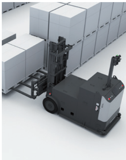
Интенсивное штабелирование (с четырьмя вилами)
