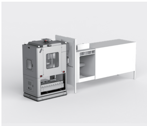
Стыковка с буферным стеллажом
