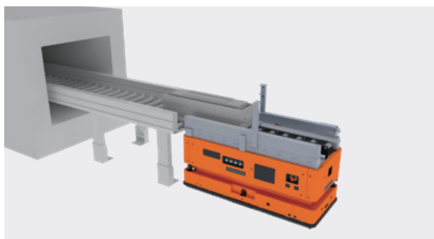
Транспортировка устройства для дегуммирования в фотоэлектрической промышленности
