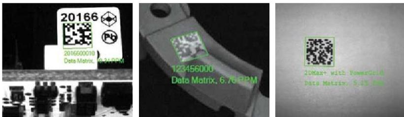
*Считыватели 1D/2D кодов на основе захвата изображения*
