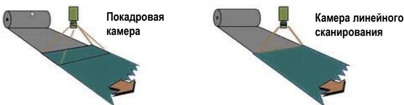
Выбор камеры и аксессуаров зависит от реальных условий производства (ширины зоны считывания/контроля, скорости, необходимой детализации изображения и т.д.).
