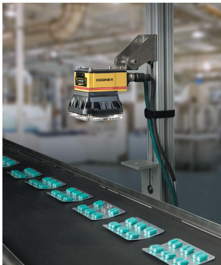
РИС. 1. ► Система контроля таблеток и капсул в блистерах на базе решений Cognex
