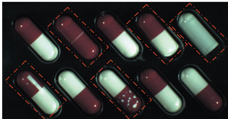
РИС. 5. ► Пример дефектов капсул, подлежащих контролю
