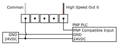
Для подключения высокоскоростных выходов к реле, светодиоду или подобной нагрузке подключите отрицательную сторону нагрузки к выходу, а положительную сторону - к +24 В постоянного тока. Когда выход включается, отрицательная сторона нагрузки сбрасывается до уровня менее 3 В постоянного тока, и через нагрузку появляется 24 В постоянного тока. Используйте защитный диод для большой индуктивной нагрузки, с анодом, подключенным к выходу, и катодом, подключенным к + 24 В постоянного тока.
