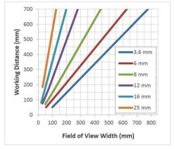
Диаграмма ниже показывает зависимость ширины поля зрения видеодатчика **In-Sight 2000- 110/120/130/130C** от дистанции и используемого объектива при разрешении видеодатчика 640 x 480 (режим увеличения изображения 2X.
