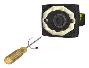
4. Снимите светодиодный модуль.
