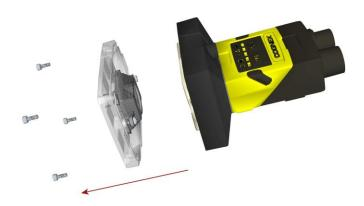
3. Используя отвертку, ослабьте два винта на светодиодном кольце.
