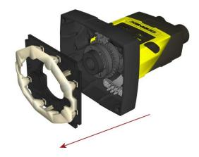
5. Аккуратно выровняйте разъем на задней части светодиодного модуля с помощью направляющих штифтов на датчике. Осторожно вставьте светодиодный модуль.
