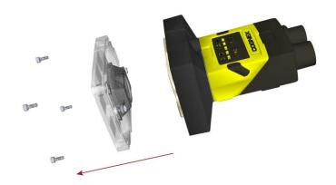
3. Отвинтите два винта на держателе фильтра и снимите держатель фильтра с передней крышки.
