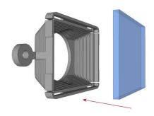
5. Установите держатель фильтра обратно на переднюю крышку, затянув винты, пока они не перестанут вращаться.
