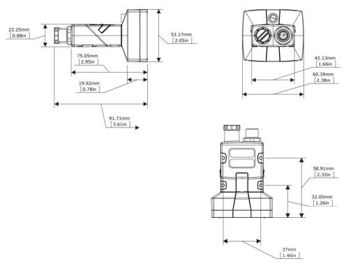
Размер датчика зрения в угловой конфигурации показан на следующем рисунке:
