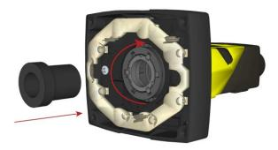
6. Установите на место переднюю крышку. Затяните все четыре винта с помощью динамометрического ключа; Максимальный крутящий момент составляет 0,2 Нм.
