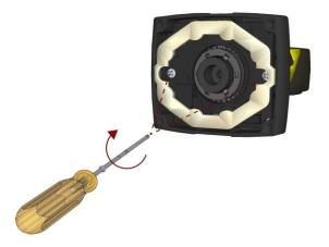
7. Установите на место переднюю крышку. Затяните все четыре винта с помощью динамометрического ключа; Максимальный крутящий момент составляет 0,2 Hм
