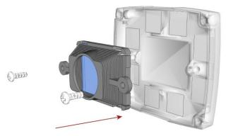
6. Установите на место переднюю крышку. Затяните все четыре винта с помощью динамометрического ключа; Максимальный крутящий момент составляет 0,2 Hм
