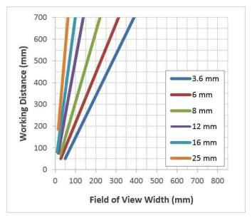
Диаграмма ниже показывает зависимость ширины поля зрения видеодатчика **In-Sight 2000-130/130C** от дистанции и используемого объектива при разрешении видеодатчика 800 x 600 пикселей (Режим увеличения
