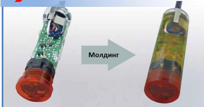
Термоклеевой молдинг обеспечивает высокую устойчивость к вибрации до 100 Гц, 8 часов.
