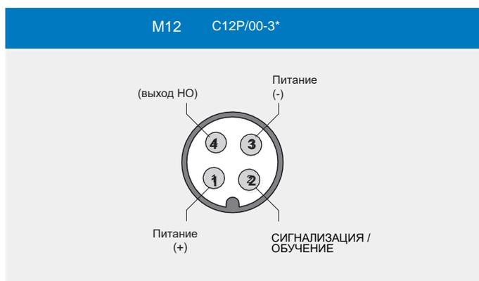
Если сигнализационный выход отключён, он должен быть соединён с POS
