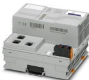
Аxioccontrol для управления устройствами ввода-вывода Axioline F напрямую. С 3 разъемами Ethernet для подключения дополн. децентрал. уст-в ввода-вывода через PROFINET, Modbus TCP или TCP/IP. Программирование согл. МЭК 61131-3. В комплекте с соединит. штекером и держателем маркировки.
