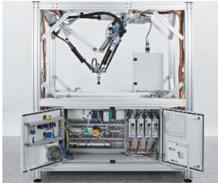
**РИС. 2.** Система перемещения с универсальным шкафом управления
