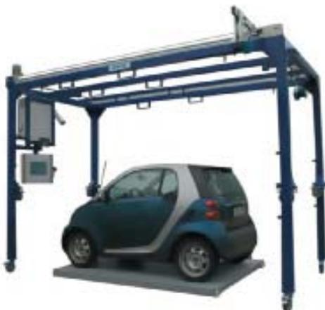
Используемый в системе принцип действия обеспечивает ее высокую надежность. Так, например, отклонение от горизонтали на  $\pm 5^\circ$  не приведет к получению ошибочных показателей. Весь процесс измерения запускается при сканировании штрихкода на объекте. Как только ручной сканер считывает действительный код, система использует результат взвешивания для запуска привода линейной оси и измерения объема объекта.
