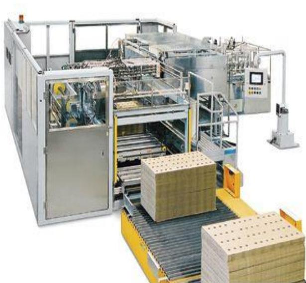
**Машины для производства картонной упаковки** вырезают и запечатывают, либо вырезают, заполняют и запечатывают картонные бланки или сложенные и заклеенные по боковому шву коробки.
